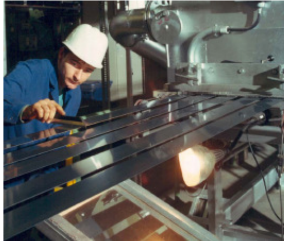
Figura 9: Foto das tiras temperadas e revenidas [3].
