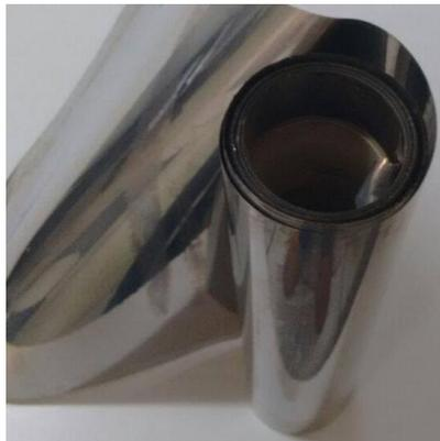
Os problemas de tratamento térmico como contaminação (oxidação, nitrogação e etc.) e descarbonetação (no caso de aços) podem ser resolvidos com o uso de “foil”.
