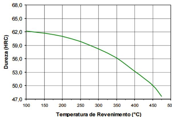
Curva obtida após tratamento térmico em corpos de prova de 20 x 20 mm<sup>2</sup>.
